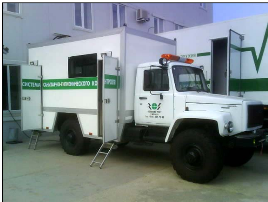
Фото 3 – Передвижная лаборатория контроля воды и почвы
