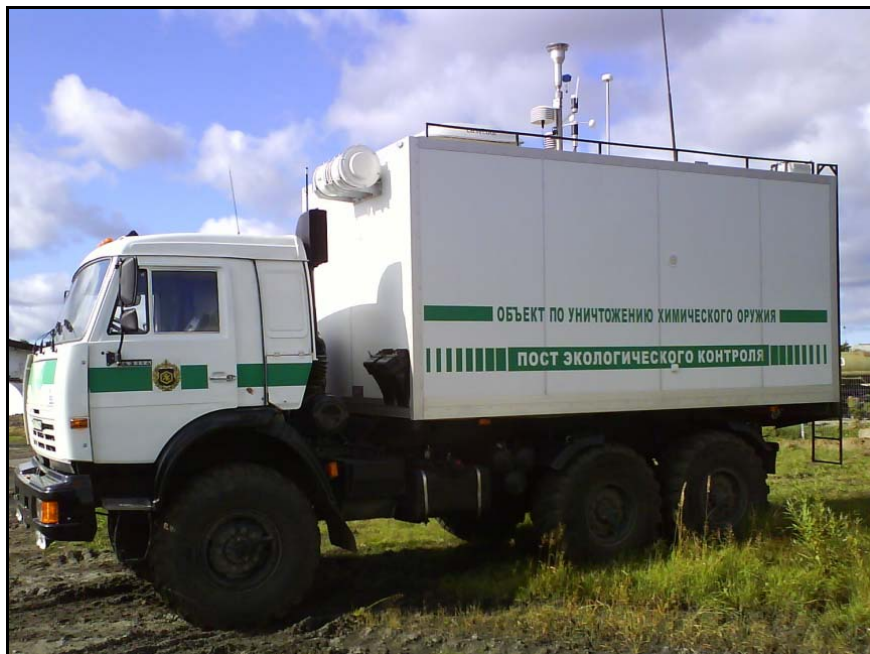
Фото 2 – Передвижная лаборатория контроля атмосферного воздуха
